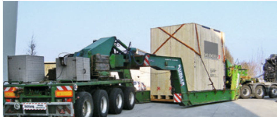
Mit dieser Kesselbrücke erreichte die GROUP7-Ladung per Sondertransport sicher das Binnenschiff in Mannheim
