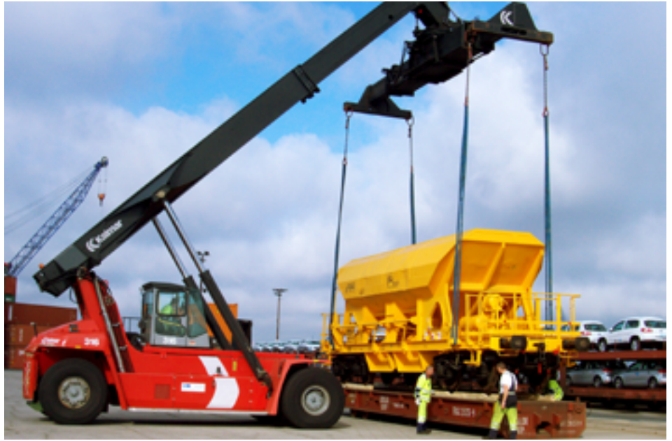
Fixierung von Wagons mit je 22,5 Tonnen Gewicht für die Reise per RoRo-Schiff
